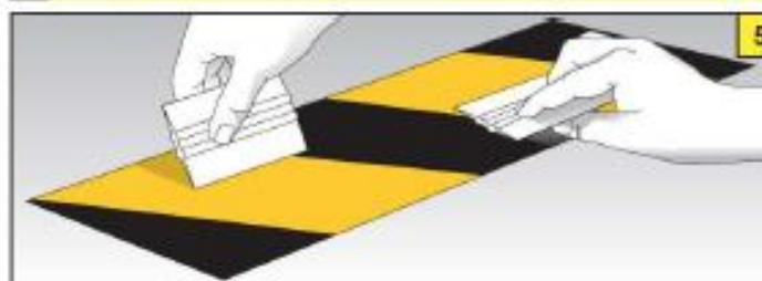
5. Debe aplicar la lámina con la rasqueta, presionando desde el centro hacia afuera con una ligera presión. Presionar de nuevo firmemente sobre las esquinas y bordes
