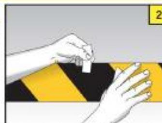
2. Extender y alinear la lámina sobre la superficie marcada. En caso necesario, colocar unas cintas autoadhesivas sobre las líneas de apoyo y presionar la parte sin papel protector con la rasqueta.
