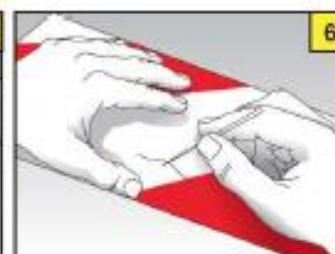
6. Perforar con una aguja posibles burbujas que aparezcan tras su aplicación, presionando hasta extraer el aire
